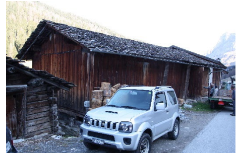
Gestrickte Doppelstallscheune mit nachträglich angebrachten vertikalen Brettverschalung. Auf der Baute steht die Datierung 1951 (vermutlich Baujahr).
